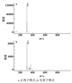
图 2 盐酸莱克多巴胺-D<sub>6</sub> 的 ESI-MS 谱图
