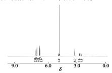
图 1 盐酸莱克多巴胺-D<sub>6</sub> 的 <sup>1</sup>HNMR 谱图
